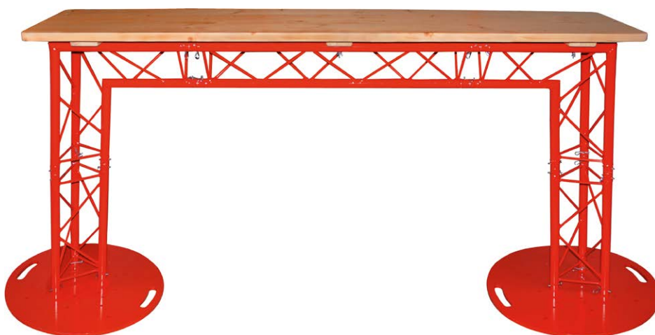
Anwendungsbeispiel eines Traversentisches mit roter Pulverbeschichtung. Bestehend aus einer 100 cm und zwei 50 cm Strecken, zwei C25 Winkeln 90° (Spitze innen) und zwei runden Universal Bodenplatten aus Stahl.
